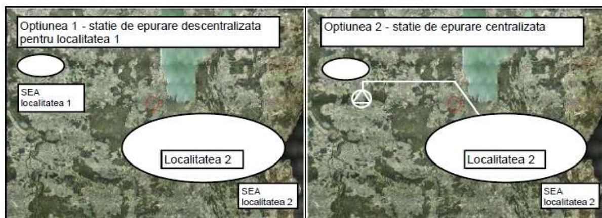
Figura 5-7. Opțiuni generale de evacuare a apelor uzate.
